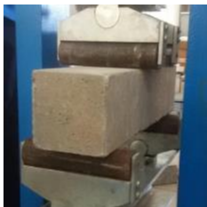
Hình 3.7: Thí nghiệm cường độ kéo khi uốn với sơ đồ uốn 4 điểm
