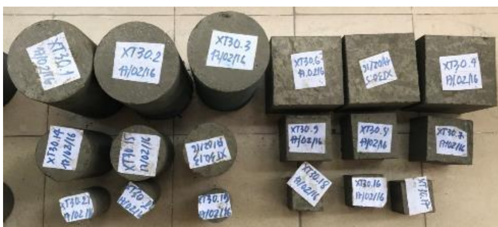
Hình 3.3: Mẫu thí nghiệm với các kích thước khác nhau
